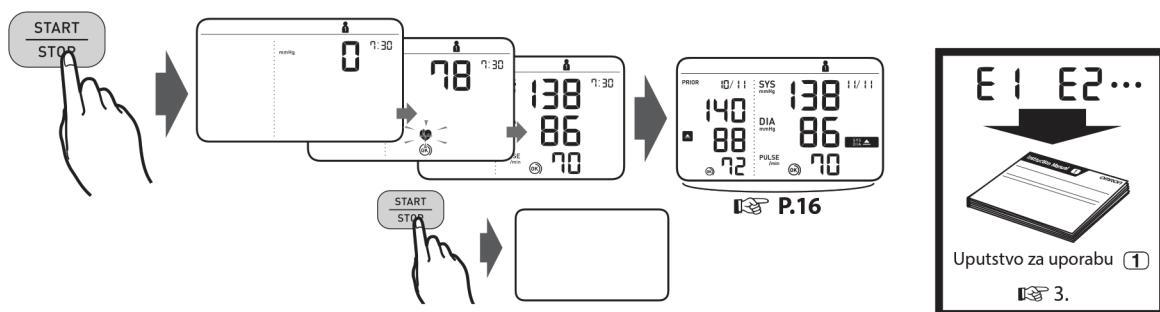
Kad se pritisne tipka [START/STOP], mjerenje se automatski snima i sprema.
